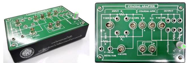
ภาพที่ 5 ชุดทดลองคลื่นยืนบนสายส่ง
